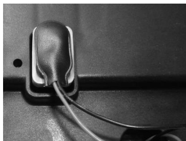
9 V:s backupbatteri för nödlägesänkning
